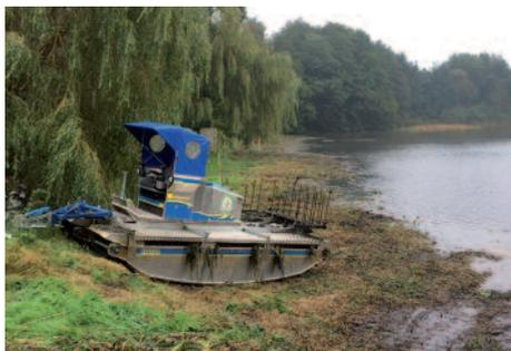
Auf dem Mühlenteich fuhr kürzlich ein merkwürdiges Gerät. Dieses Schwimmfahrzeug kann den Schilfgürtel unter der Wasseroberfläche abmähen, das Mähgut einsammeln und ans Ufer zum Ab-
