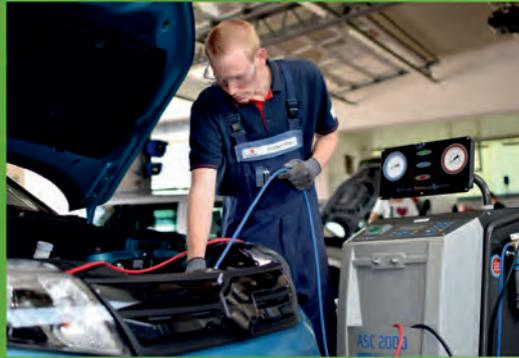
Daher empfehlen wir die Klimaanlage regelmäßig warten zu lassen. Nach der Funktionsprüfung wird das Kältemittel abgesaugt und recycelt. Anschließend wird die Klimaanlage mit Kältemittel genau nach Herstellervorgabe komplett neu befüllt. So kommen Sie auch im Hochsommer im Auto nicht so leicht ins Schwitzen.
