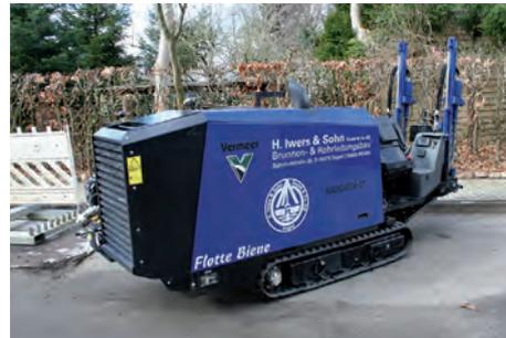
den in der Folgezeit neue Wasserleitungen verlegt. Dazu bediente man sich der Technik des unterirdischen horizontalen Spülbohrverfahrens. Nur an einigen Stellen mussten der Bürgersteig bzw. der Kreuzungsbereich dafür „geöffnet“ werden. Immer wieder wurden die Arbeiten durch Hindernisse, wie z.B. Gullyschächte mit unklarem Verlauf, erschwert. Die alten Wasserleitungen gilt es zu verdämmen, d.h. es wurde stellenweise eine Betonmasse eingegossen, damit keine Hohlräume entstehen.
