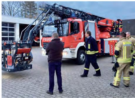
Bezeichnung Drehleiter lässt sich nur vor dem Hintergrund der historischen Entwicklung dieser Rettungsgeräte verstehen. Gedreht wird da nichts mehr, sondern es gibt Bildschirme oder kleine Sticks, über die die neue Leiter mit dem Finger bedient wird. Die neueste Ausführung, zugleich das erste Fahrzeug, das für die Wehr neu angeschafft wurde, ist ein hydraulisch gesteuertes Highend- Rettungsgerät, welches vielfältige Einsatzmöglichkeiten in unserer Region haben wird.
